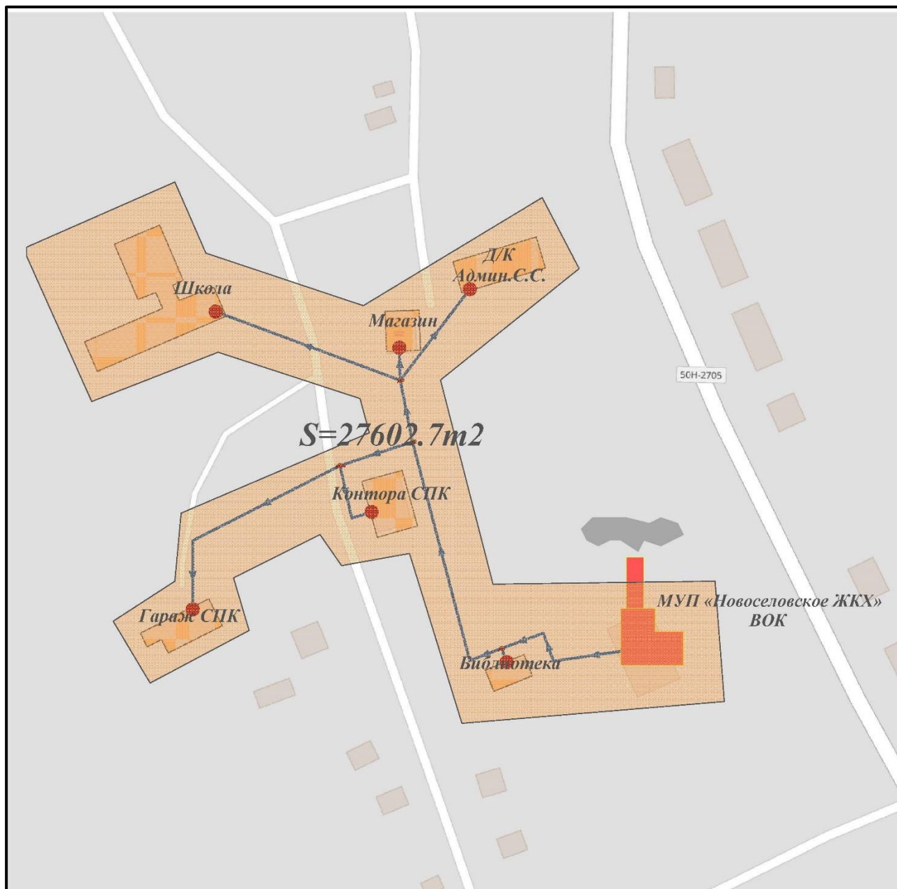
Рисунок 1.1.3.1 – Зона действия отопительной котельной
