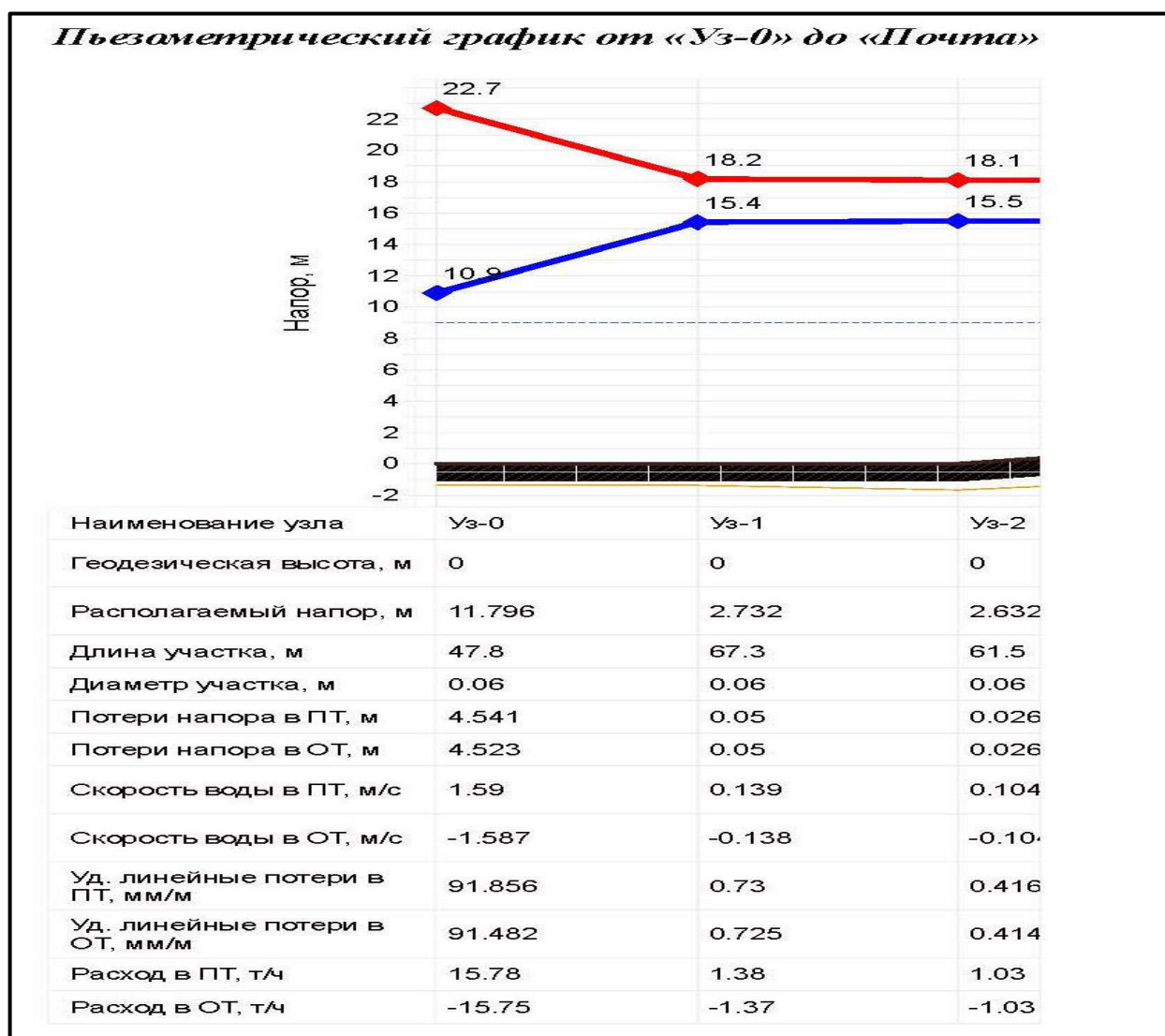
Рисунок 1.3.8.1 – Пьезометрический график по пути: Уз-0 – Почта
