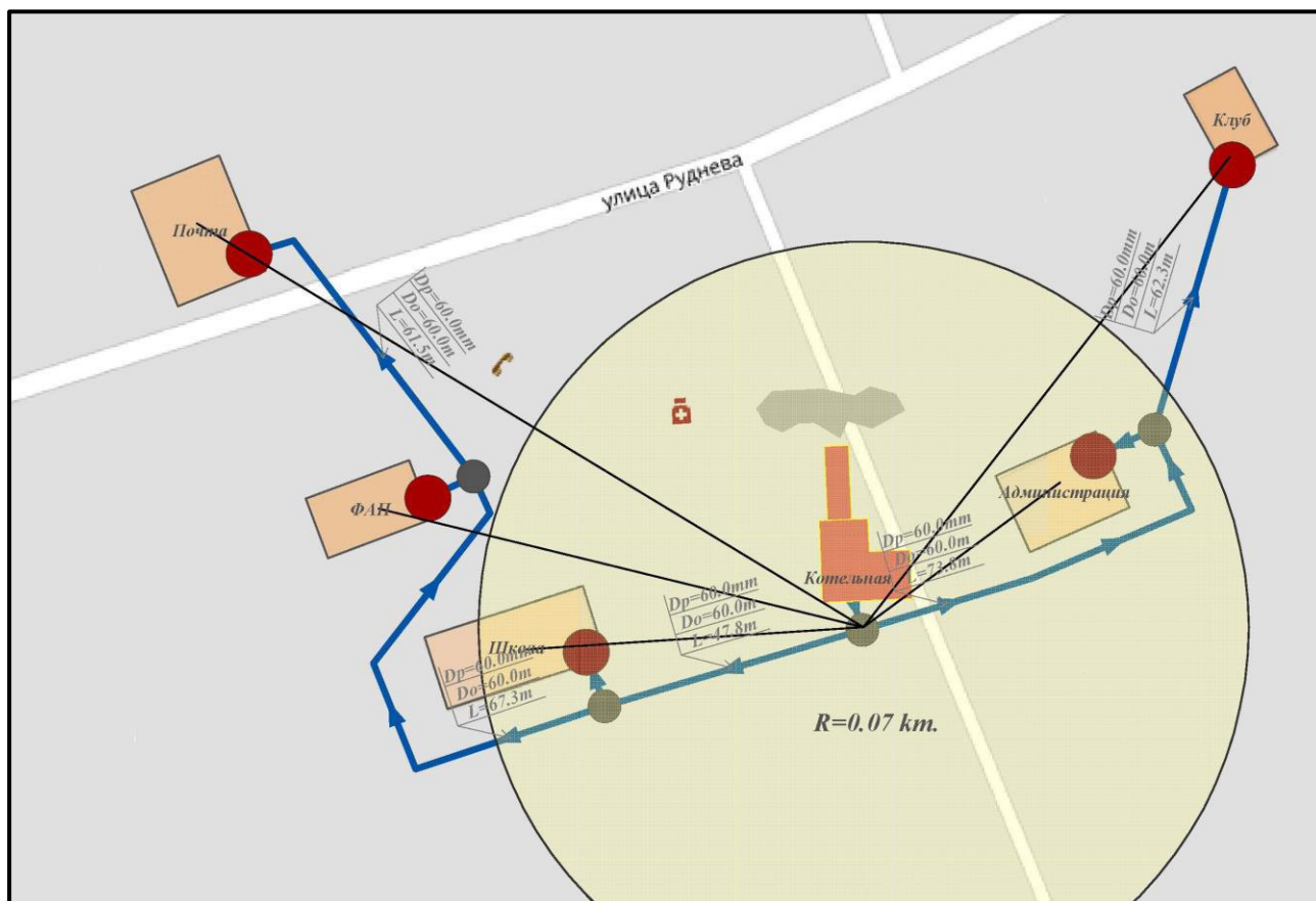
Рисунок 2.5.1 – РЭТС Муниципальной котельной
